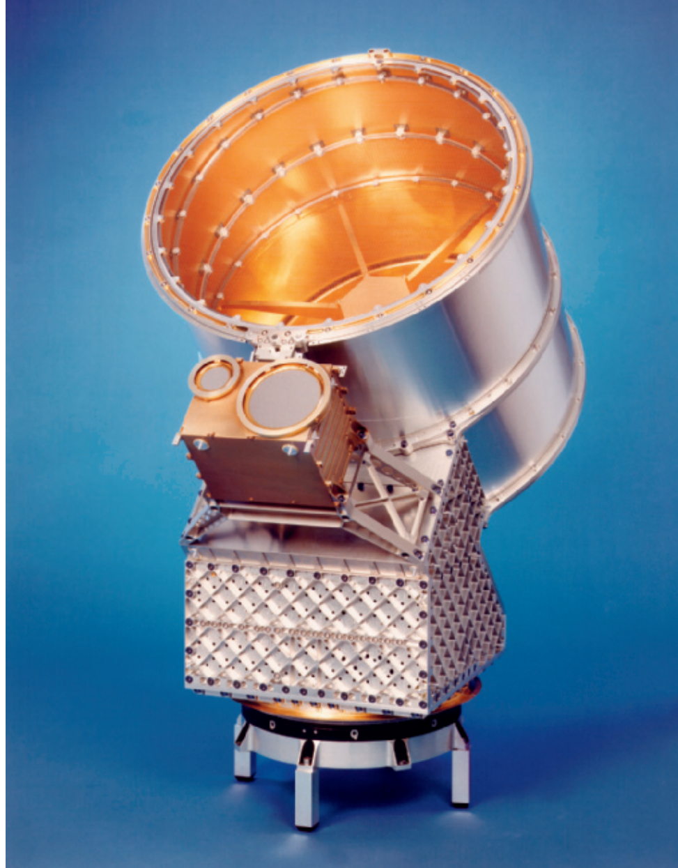
Wertvolles Stück: der 17 Kilogramm schwere Cosmic Dust Analyzer (kurz: CDA), eingepackt in glänzende Thermisulationsfolie. Das Instrument an Bord der Raumsonde Cassini analysiert die Umgebung des Ringplaneten Saturn. Zur Ausrichtung besitzt der Staub-Detektor einen Drehtisch.
